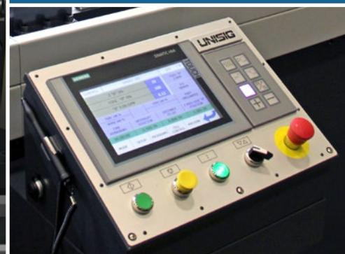
UNISIG-MASCHINENSTEUERUNGEN basierend auf Siemens Industriekomponenten sind einfach einzurichten und ermöglichen unbeaufsichtigtes Bohren mit Prozessüberwachung und automatischer Unterbrechung.
