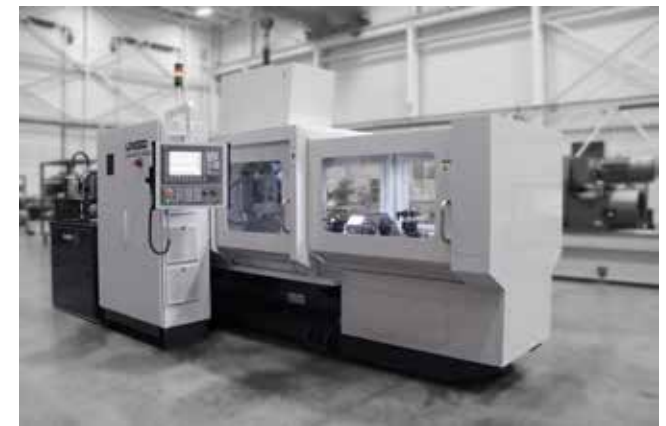
CNC positioning, rotary motion and modular workholding are available for complex drilling operations in production Für komplexe Bohrvorgänge in der Produktion stehen CNC-Positionierung, Drehbewegung und modulare Werkstückspannung zur Verfügung
